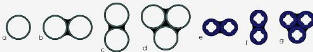
a - jednuška b - dvojka c - broková kozlice d - brokový troják e - dvoják f - kulová kozlice g - kulový troják
